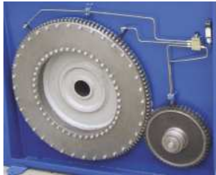
Kuggdrift och automatsmörjning för hög driftsäkerhet
